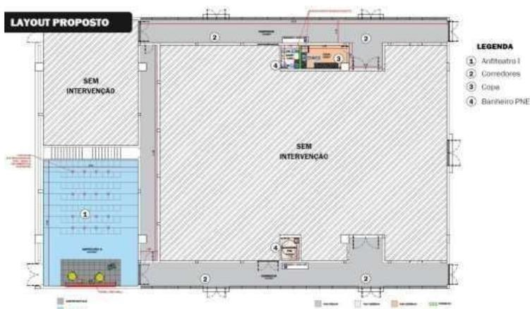
Figura 05 - Planta baixa do Complexo de Eventos (Prédio 05) com destaque para os espaços internos que sofrerão intervenção (áreas coloridas)
