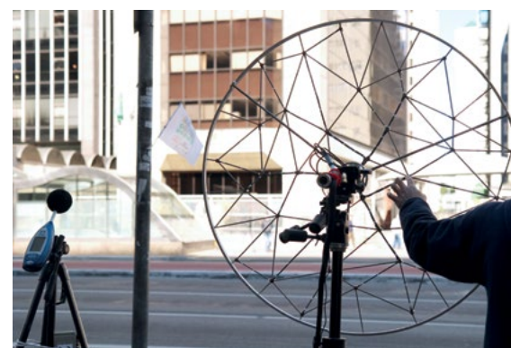
Holografia acústica para mapeamento de ruído
