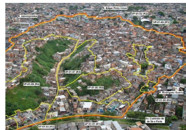
Setorização de risco em foto oblíqua captada por drone
